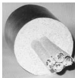
Заделка кабельных проходок мастикой МГКП
